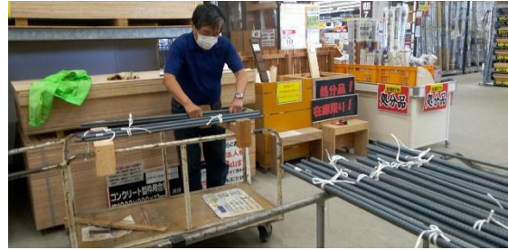
鉄杭用16mm,13mm丸棒切断作業
