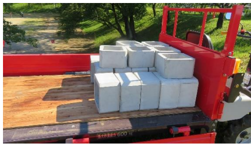
枡形コンクリート枠(24cm角、高さ15cm)
